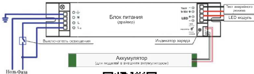
Схема подсоединения сетевых проводов в клеммные разъемы БАП
