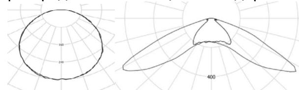
Светодиод без вторичной оптики, с овальной оптикой не позволяет получить светильник с эффективной кривой силы света.
